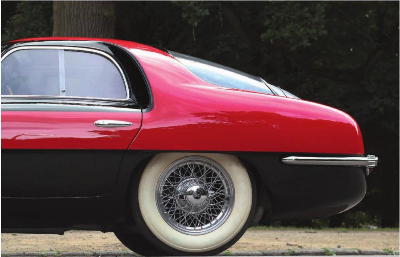
Le tiers arrière fait preuve d'une belle audace avec deux tunnels latéraux pour capter les flux d'air en aval des portières.
