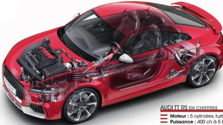
Le TT RS adopte de série la transmission intégrale quattro, mais le 5-cylindres 2.5 TFSI de 400 ch étant placé transversalement, celle-ci est de type Haldex, plus légère et compacte que le Torsen.
