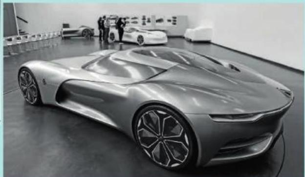
Après la classique mais incontournable étape des dessins, la réalisation de maquettes à l'échelle 1 a été démultipliée avec le projet Trezor. Ce concept est différent d'un projet classique puisqu'il dispose d'une coque-habitacle et d'une coiffe qui englobe toute la partie frontale.
