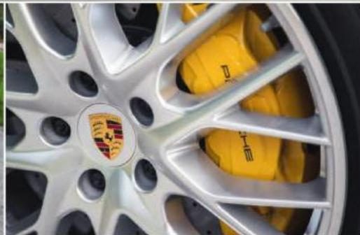
Reconnaisables aux étriers jaunes à 10 pistons à l'avant et à 4 pistons à l'arrière, le freinage en céramique optionnel accueille des énormes disques de 420 mm de diamètre à l'avant et de 390 mm à l'arrière.
